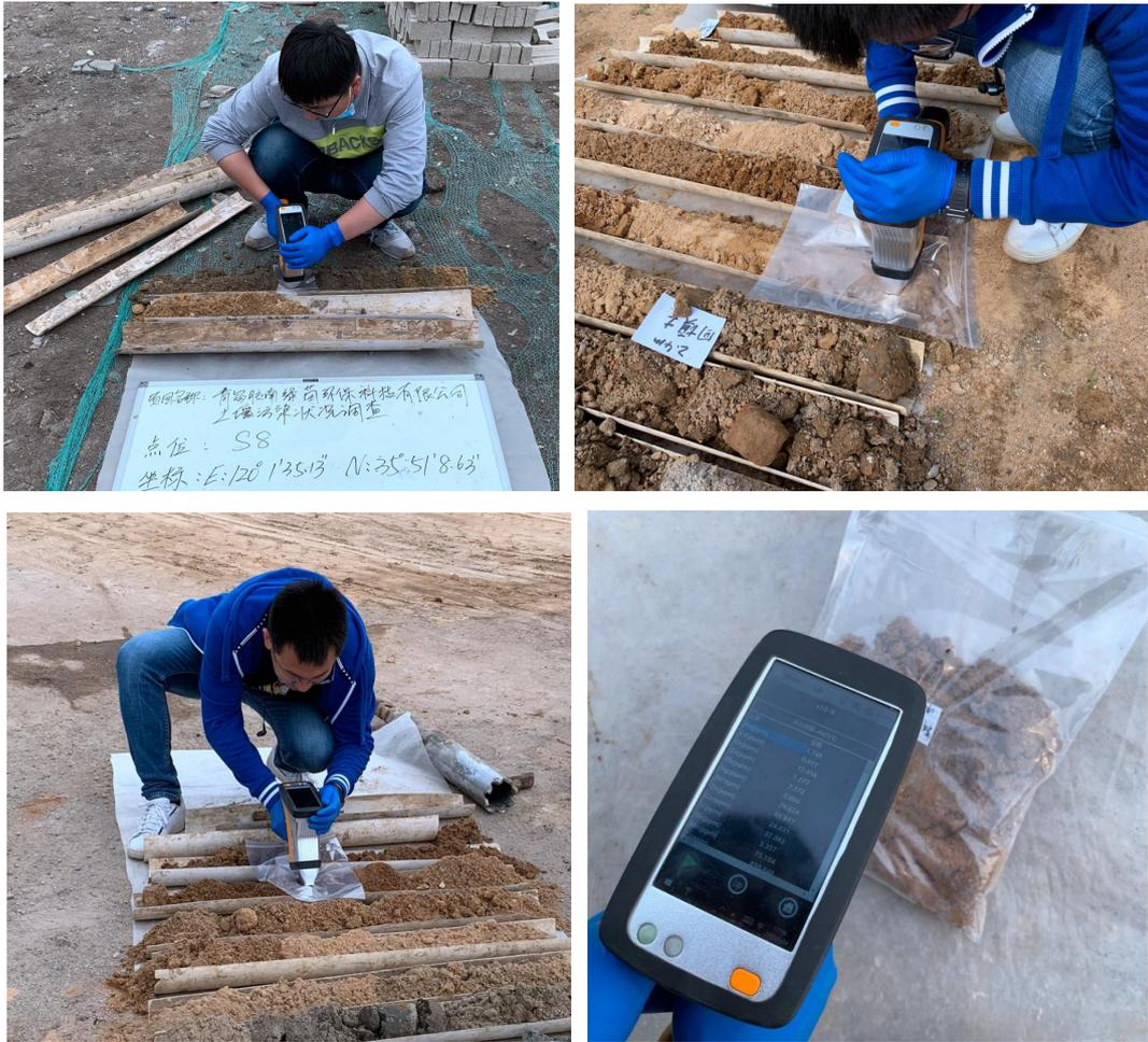
图 5-8 现场 XRF 快速检测
